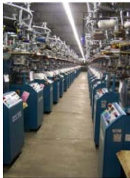
L'investissement industriel, de l'ordre de 800 000 € par an a rendu possible le renouvellement du parc : métiers full électroniques Lonati de la nouvelle génération, remailage automatique ou machines de coutures pointes Rosso, formeuses de haute technicité, circuits de packaging semi-automatiques etc.... Cet effort s'est accru en 2010/2011 (1.2 million d'euros) pour permettre l'acquisition des 50 nouveaux métiers à tricoter nécessaires à la production d'Olympia.
